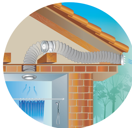
VKOk fan cottage ventilation example
